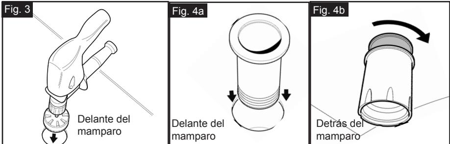
**PASO 3** Pase la carcasa a través del orificio.
