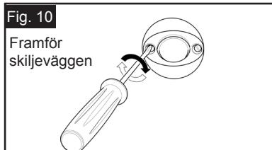
**STEG 4.** Placera höljet genom hålet (Se Fig. 9). Installera genom att dra åt de 2 skruvarna i framkanten tills flänsen är monterad säkert på skiljeväggen (Se Fig. 10), d.v.s att den täcker hela omkretsen. Kontrollera att skruvhålen är på en horisontell yta.
