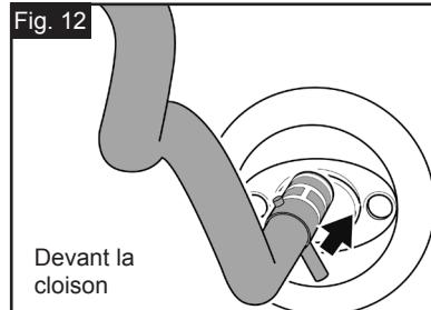
**ETAPE 6** Insérer le flexible dans le support jusqu'à ce que la douchette soit en place. (Voir Fig. 12).
