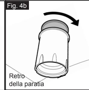
**FASE 3** Collegare il supporto nel foro. Stringere manualmente il dado di bloccaggio sul supporto dietro la paratia. Vedere Fig. 4a e 4b.
