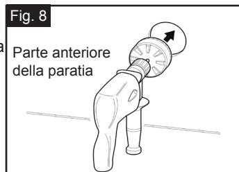
**FASE 3** Verificare che l'anello di supporto di colore nero sia collocato al suo posto, dietro il supporto. Se quest'ultimo deve essere collocato su una superficie curva, sostituirlo con l'anello di supporto appropriato, secondo le indicazioni che seguono:
