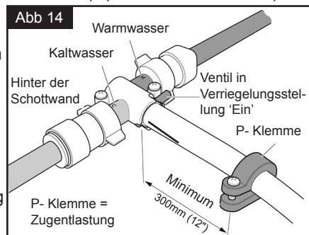
**SCHRITT 4 ANBRINGEN DER P-KLEMME AN DER SCHOTTWAND.** Schrauben Sie die P-Klemme in die Schottwand. Achten Sie dabei darauf, dass diese mindestens 300 mm (12") vom Ventilgehäuse entfernt ist (siehe Abb. 14).
