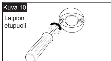
**VAIHE 4** Työnnä kotelo läpi asennusreijästä (kuva 9). Asenna kiristämällä kaksi ruuvia etupuolelta kunnes laippa on tukevasti kiinnitetty laipioon (katso kuva 10). Sen tulee koskettaa laipiota joka kohdaltaan. Varmista, että ruuvireiät ovat vaakasuorassa suunnassa.
