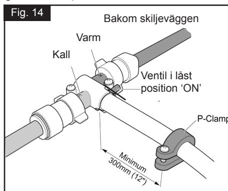
**STEG 2** KOPPLA TILL P-CLAMP TILL SKILJEVÄGGEN. Skruva på p-clampen på skiljeväggen och kontrollera att den sitter minst 300 mm (12") från ventilhölet (Se Fig. 14).
