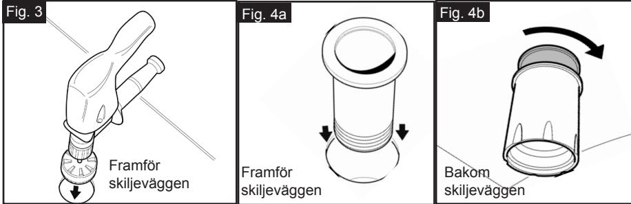
**STEG 3** Placera höljet genom hålet. Spänna låsmuttern för hand bakom skottet. Se Fig. 4a och 4B.
