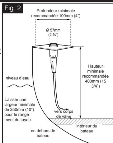
**ETAPE 2** En respectant les restrictions de largeur et de hauteur indiquées dans la Fig. 2, percer un trou de 50 mm de diamètre dans la cloison audessus de la ligne de flottaison. (Voir Fig. 3) Remarque: épaisseur de surface de montage minimum: 3 mm; épaisseur de surface de montage maximum 19 mm.
