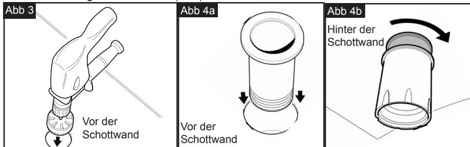
**SCHRITT 3** Schieben Sie das Duschgehäuse in das Loch. Sichern Sie das Gehäuse, indem Sie die Sicherungsmutter auf dem Gehäuse hinter der Schottwand mit der Hand festziehen. Siehe Abb. 4a und 4b.
