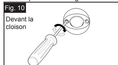
**ETAPE 4** Insérer le support dans le trou (Voir Fig. 9) Installer celui-ci en serrant les 2 vis par la face avant jusqu'à ce que la corolle du support soit correctement installée sur la cloison (Voir Fig. 10) c.-à-d. en étant en contact sur tout le pourtour. Vérifier que les trous de vis se situent sur un plan horizontal.
