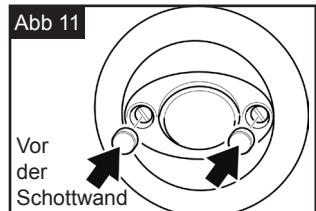
**SCHRITT 5** Drücken Sie die Kunststoffkappen mit der Hand in die Schraubenlöcher. (Siehe Abb. 11).
