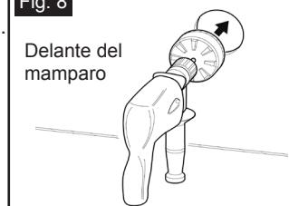
**PASO 3** Coloque la arandela de soporte de color negro detrás de la carcasa. Si la carcasa se va a colocar en una superficie curva, reemplácela por la arandela de soporte apropiada, como se explica a continuación.
