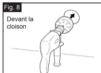
**ETAPE 3** Vérifier que la bague d'appui noire est en place derrière le support. Si le support doit être installé sur une surface incurvée, remplacer celle-ci par la bague d'appui appropriée telle que détaillée ci-dessous:
