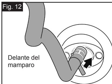
**PASO 6.** Haga pasar la manguera por la carcasa hasta que la alcachofa se coloque en su lugar. (Ver Fig. 12). Consulte la sección 8 para la instalación de la tubería.
