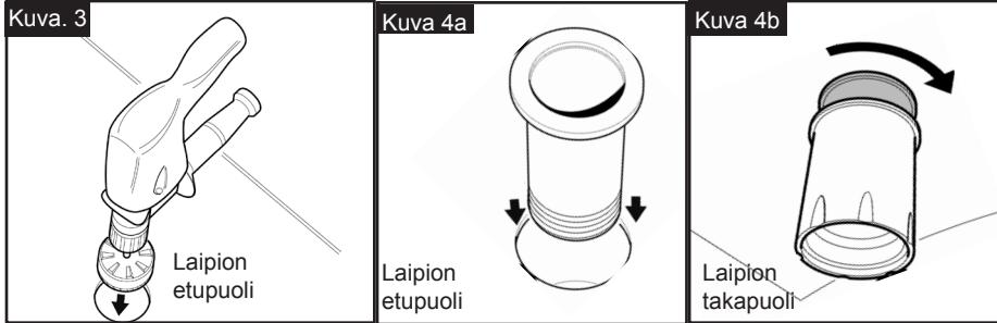
**VAIHE 3** Paina kotelo reiästä läpi. Kiristä lukitusmutteri käsitiukkuuteen laipion takapuolelta. Katso kuvat 4a ja 4b.
