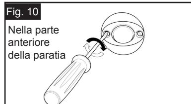
**FASE 4** Collocare il supporto nel foro (Vedere Fig. 9). Installare stringendo bene le 2 viti nella parte frontale fino a che la flangia non sia fissata saldamente alla paratia (Vedere Fig. 10), cioè ben aderente in tutti i punti della circonferenza. Verificare che i fori delle viti si trovino su un piano orizzontale.
